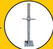
Es un acero sólido de 24" con varilla roscada y soldada a la placa de base en un ángulo de 90°. Capacidad de carga a 18" es 53,000 lbs.
