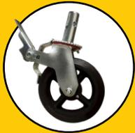
El embone de esta rueda giratoria es de  $1\frac{3}{4}$ " de diámetro exterior con 4" de largo. Es resistente hasta 500 lbs con un margen de seguridad de 8 A 1
